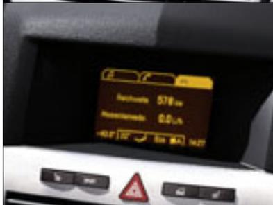
◀ **Display Multifunción Gráfico (GID).** Muestra la hora, la fecha, la temperatura exterior y actúa como pantalla del sistema de sonido, de navegación y del teléfono.
