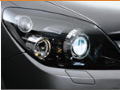
**▲ Faros Adaptativos (AFL).** En función del giro del volante y la velocidad del vehículo, los faros AFL se orientan automáticamente para anticiparte el trazado de la curva. Mayor seguridad y menor fatiga visual en la conducción nocturna.
