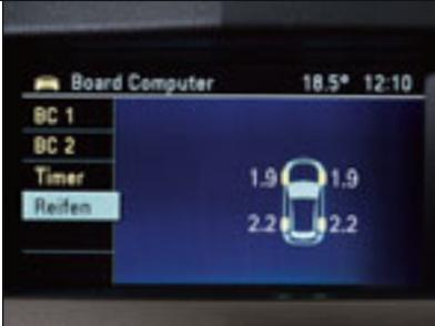
**▲ Sistema de Monitorización de la Presión de los Neumáticos (TPMS).** En caso de una significativa pérdida de presión en un neumático, muestra un mensaje de advertencia en el Display Multifunción Gráfico (GID) o en el Display en Color (CID), indicando además cuál es la rueda afectada.
