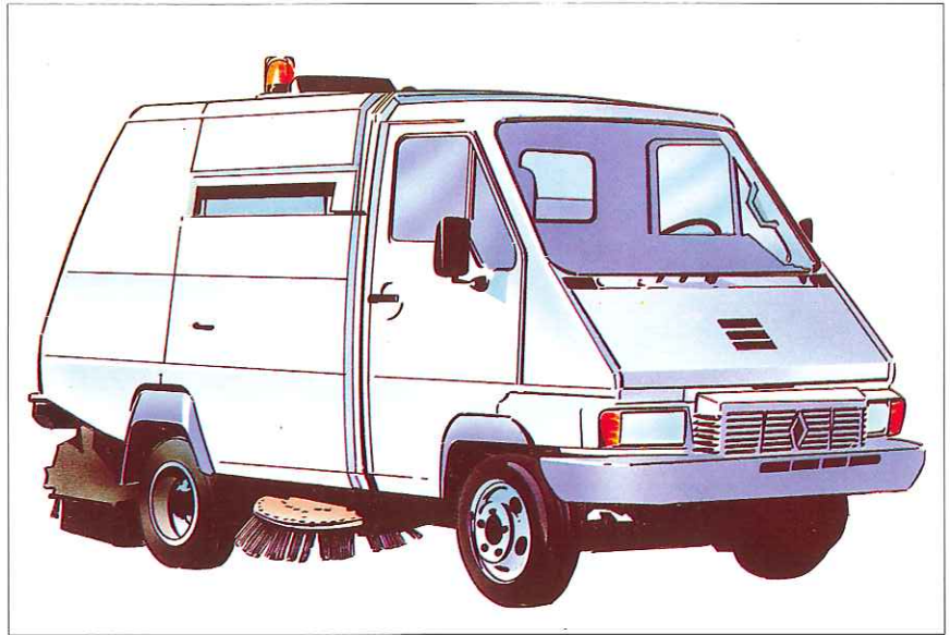
Barredora mecánica adquirida recientemente por LIPASAM, de la que disponemos de cuatro unidades. Trabaja por principio de arrastre, con lo que se obtiene un funcionamiento más silencioso. Su sistema de humectación del suelo evita la formación de polvo al barrer. Depósito de agua con capacidad de 600 litros.
