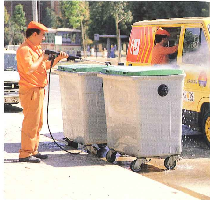
Equipo especial de limpieza con agua a alta presión.
