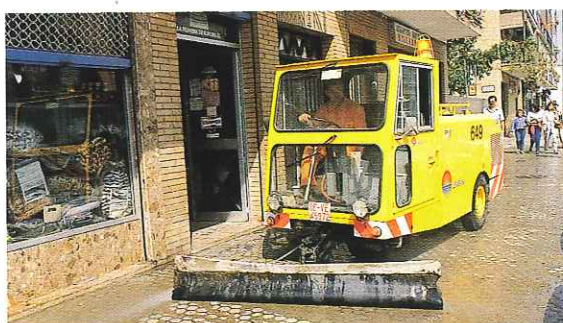
Baldeo mecánico de aceras.
