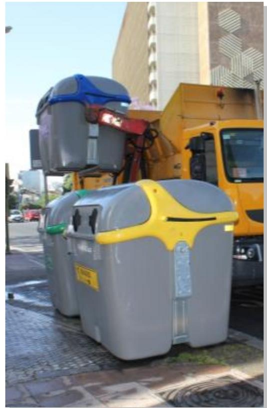
**Sustitución de Cabezales de Recogida Neumática.** A principios de 2014 se vinieron realizando pruebas con nuevos diseños de cabezal para la recogida neumática, para hacerlo más accesible, más útil y de mayor facilidad de uso. El cabezal existente era de reducida capacidad (unos 25 l) y de introducción
